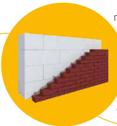
При облицовке кирпичом кладки из газобетонных блоков обязательен вентзазор и мероприятия по выводу конденсата. Облицовку можно возводить параллельно с возведением несущей стены, либо осуществлять облицовочные работы на готовой стене. Для соединения кладки из газобетона и кирпича используются гибкие связи, которые закладываются в швы или монтируются в стену газобетона. Данный вариант облицовки позволяет отказаться от дополнительного утепления.
