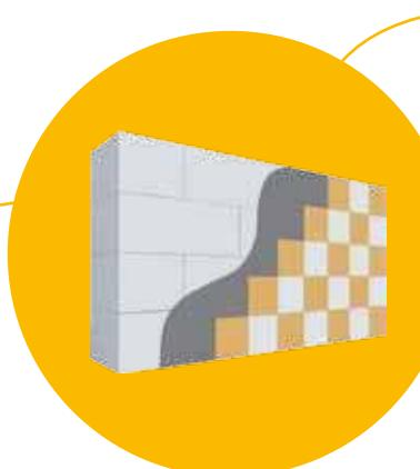
На сегодняшний день имеется огромный выбор декоративной плитки и мозаики для обустройства внутреннего пространства здания. Плитку можно крепить непосредственно к блоку, не используя дополнительные средства для выравнивания стен. В случае использования плитки в помещениях с высокой влажностью рекомендуется нанесение гидрофобизирующей грунтовки.
